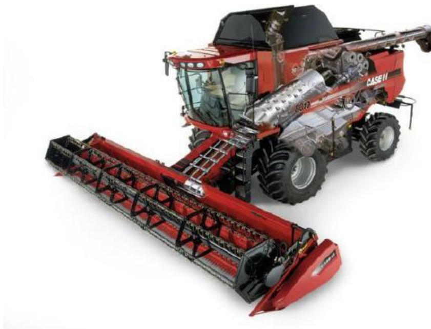
Sl. 9 Savremeni kombajn velikog učinka sa aksijalnim vršidbenim aparatom
