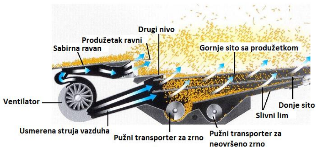
Sl. 4. Šema i delovi uređaja za čišćenje
